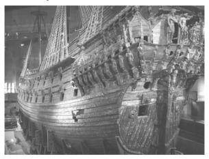
Шведский корабль, созданный по прямому указанию Короля Швеции, лично задавшего размеры и количество орудий такими, чтобы флагман стал самым большим и вооружённым на Балтике, в результате чего судно получило два ряда пушек вместо обычного одного.
