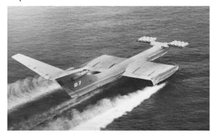
Испытывавшийся успешно двадцать лет на Каспии экраноплан — средство передвижения, использующее повышение подъёмной силы крыла в два раза вблизи поверхности, так называемый экранный эффект — долгие годы являлся самым большим летательным аппаратом на планете.
